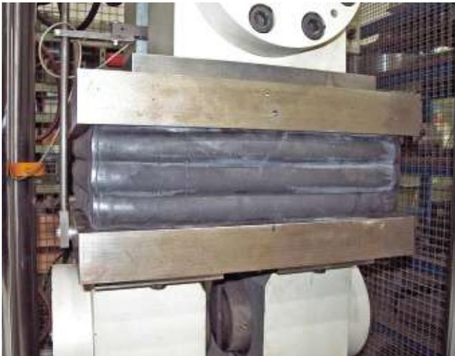
Bild 9. Gleichmäßig flache Druckstauchungswalste bei Maximalbelastung (Typ C)
